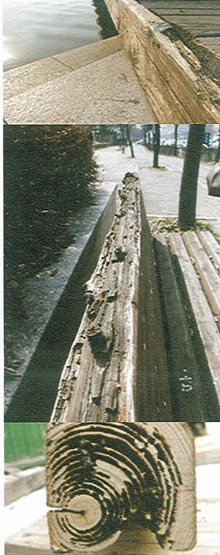
잘못 만들어진 제품은 제품에 대한 인식 자체를 달라지게 한다. 제대로 생산된 방부목과 그렇지 않은 방부목의 차이는 크다. 사진에서도 보듯이, 아름답기 위해 설치된 시설물들이 잘못된 제조로 인해 흉물스럽게 변해버렸다.
