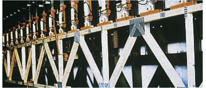
목재 트러스의 실험실 테스트
