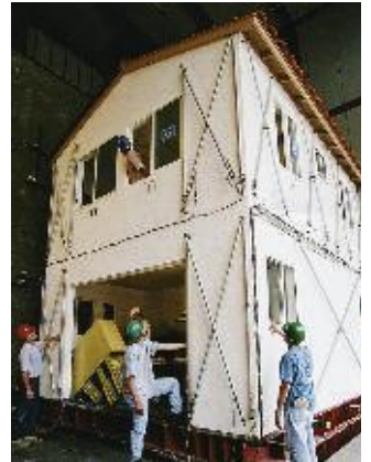
사진 11 내진설계가 실물크기의 목조건축물에 대한 시험에 의해 지원됩니다. CUREE-CALTECH 목조건축 프로젝트, 지진 공학 연구를 위한 대학 콘소시엄, 리치먼드, 캘리포니아.
