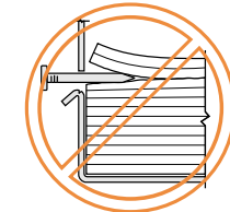
Nail at wrong angle Clavado con un ángulo incorrecto
