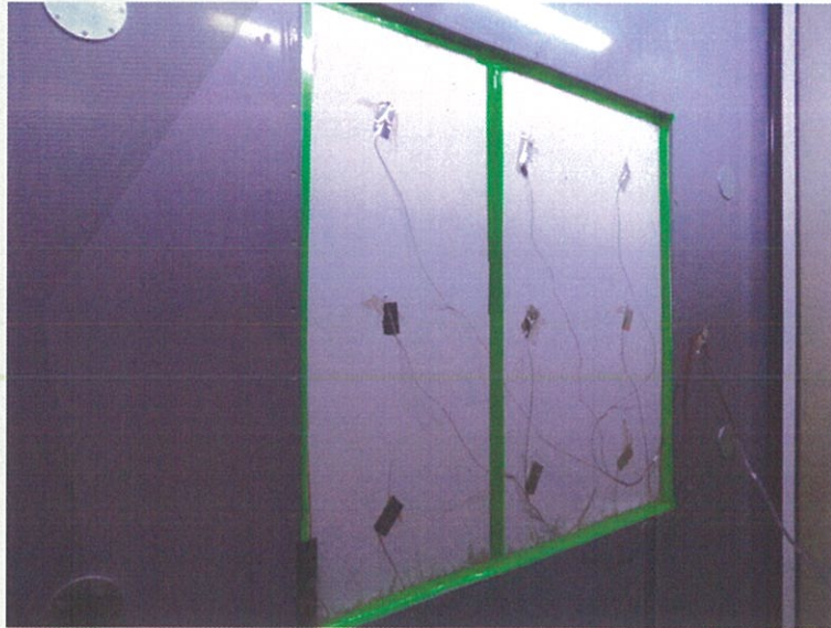
<사진 1> 항온측 시험체 모습
