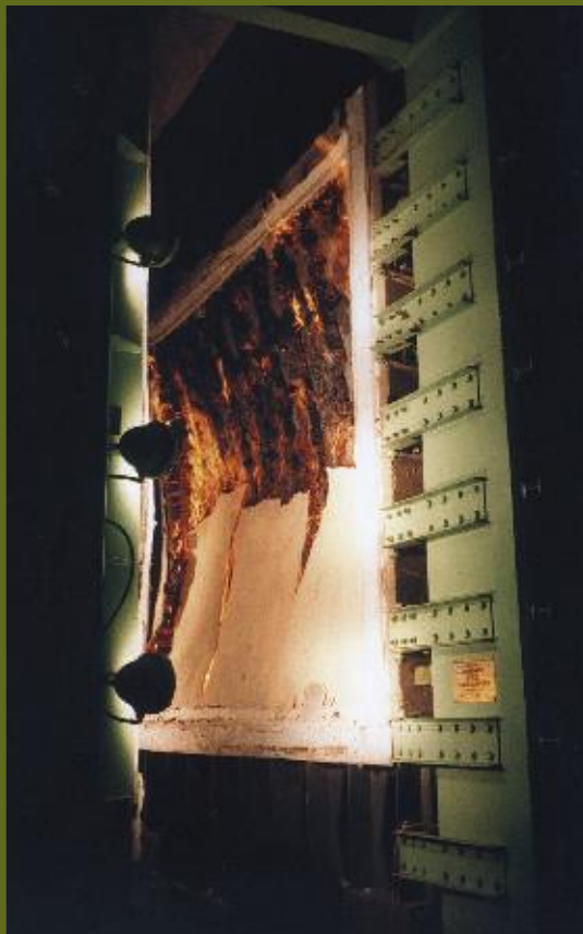
그림 2: 1시간의 화재실험 이후의 목재 �터드 벽 구조체
