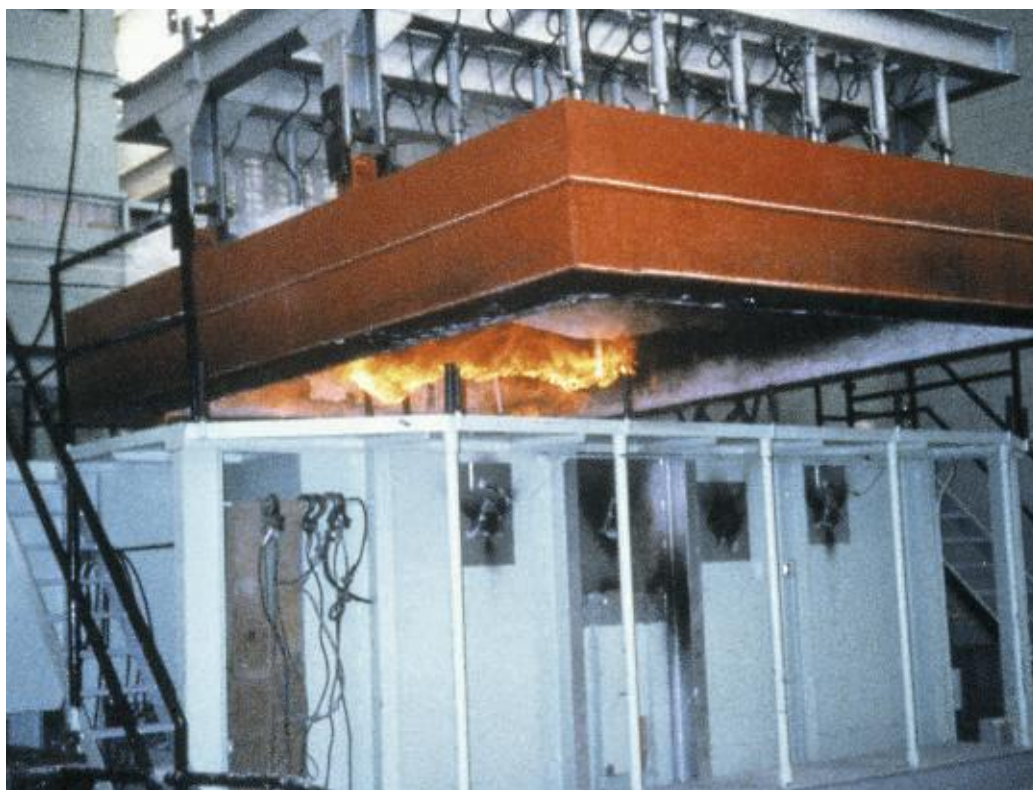
사진 4: 캐나다연구위원회(NRC)의 화재 실험실에서 실험 중인 목조 구조체
